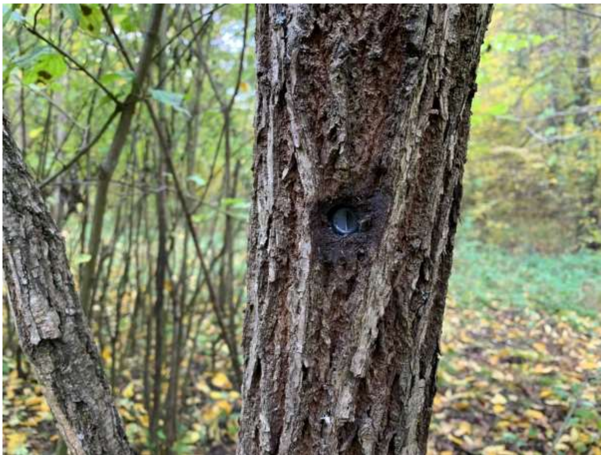
Obrázek 2 – Detail umístění sčítacího senzoru na profilu STK2 Pohansko.
